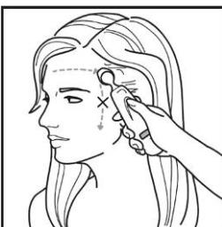
Tänk att du låter termometern följa ett imaginärt svettband. Mät rakt över pannan och inte ned längs sidan av ansiktet. Vid mittlinjen löper tinningsartären cirka 2 mm under ytan, men den kan gå djupt under ytan på sidan av ansiktet.
