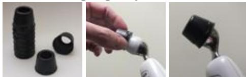
1. Sätt på skyddet genom att trycka fast det på sonden med fingrarna.
